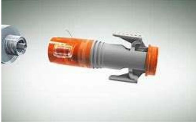
Mecanismo ToxiGuard®: consiste en un sistema de doble filtración con una matriz de carbono activado que retiene los fármacos y un filtro hidrofóbico de 0.2  $\mu\text{m}$  con una membrana esterilizante que permite la retención de materiales a través de filtración, impactación, interacciones electrostáticas y adsorción.
