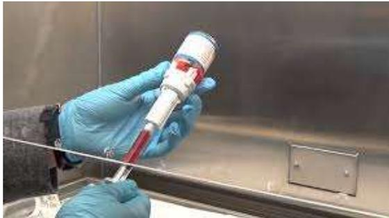
Una jeringa que incorpora un sistema de intercambio de aire-líquido de doble aguja para equilibrar las presiones. Una aguja extrae el fármaco del vial, mientras que la otra reemplaza el volumen del fármaco con un volumen igual de aire estéril de la cámara de aire.
